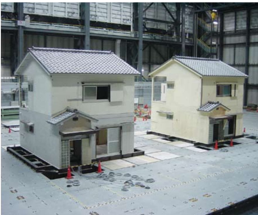
5. Prova su tavola vibrante su edifici a struttura di legno effettuata presso la tavola vibrante E-Defence del National Institute for Earth Science and Disaster prevention, Miki (Kobe, Giappone), Novembre 2005
