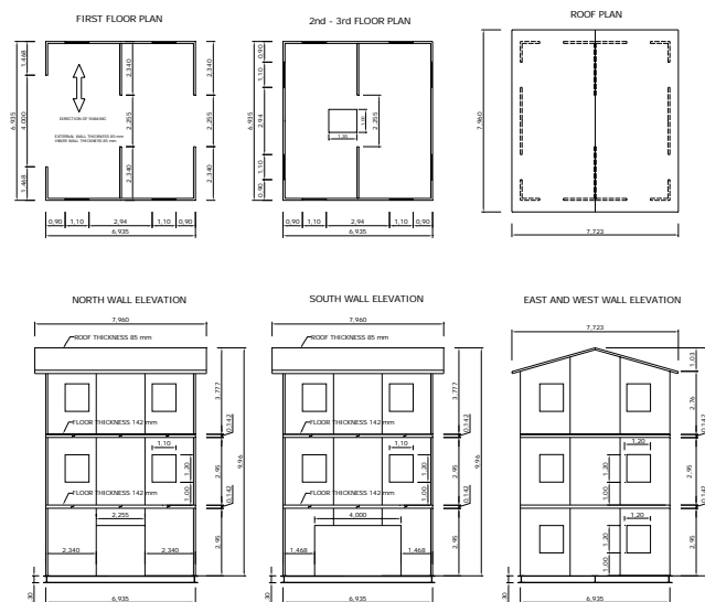
Figura 10. Piante e prospetti dell'edificio sottoposto a prova.
