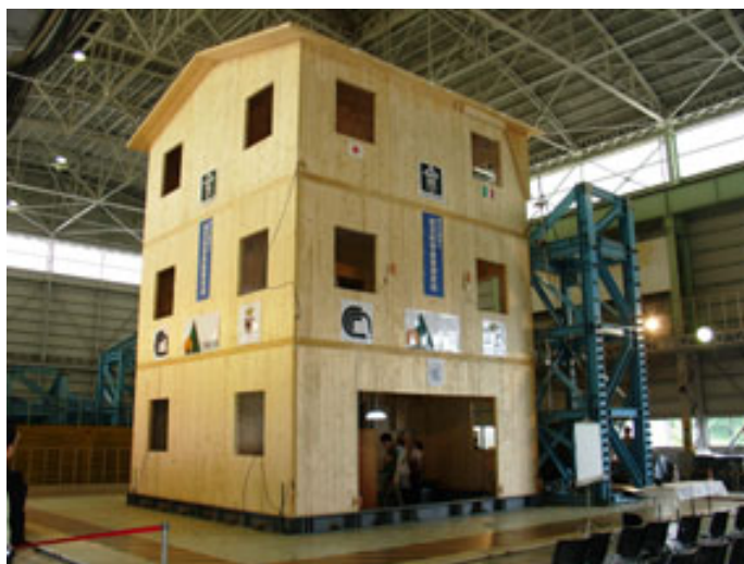
Figura 4. Edificio sottoposto a prova sopra la tavola vibrante del NIED (configurazione C).
